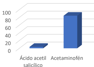
Fig. 2. Porcentaje de rendimiento de remoción 3.73% para ácido acetilsalicílico y 84.39% acetaminofén. Usando método con límite de detección (LOD) 0.461 mg/L y límite de cuantificación (LOQ) 1.536 mg/L para AAS y 0.623 mg/L (LOD) y 2.076 mg/L (LOQ) para AMP.
